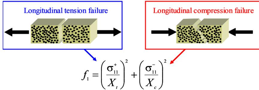
Fig. 5 : Fiber failure mode
