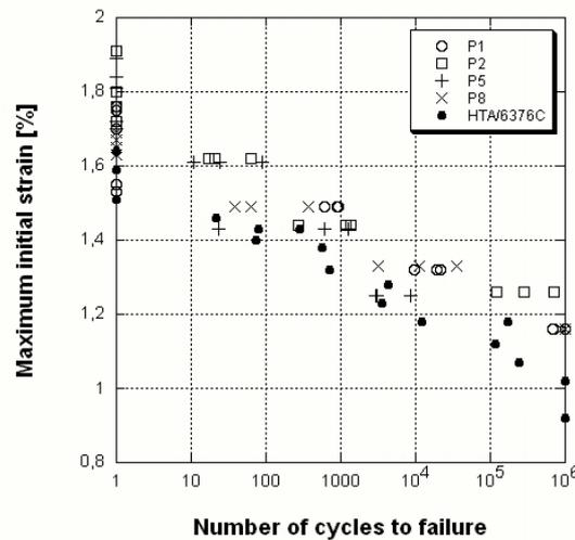
**Fig. 5.** Fatigue life diagram
